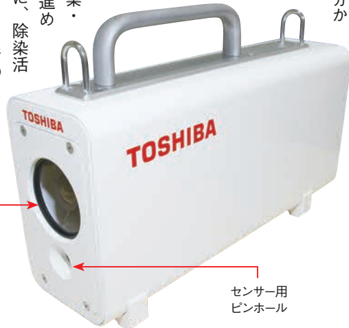
ガンマカメラはバッテリーが内蔵されていて、重量9.8kgと持ち運びが可能。低い放射線量でのホットスポットも特定できます。
