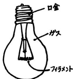
電球の中央にあるフィラメントを熱して光を出します。
